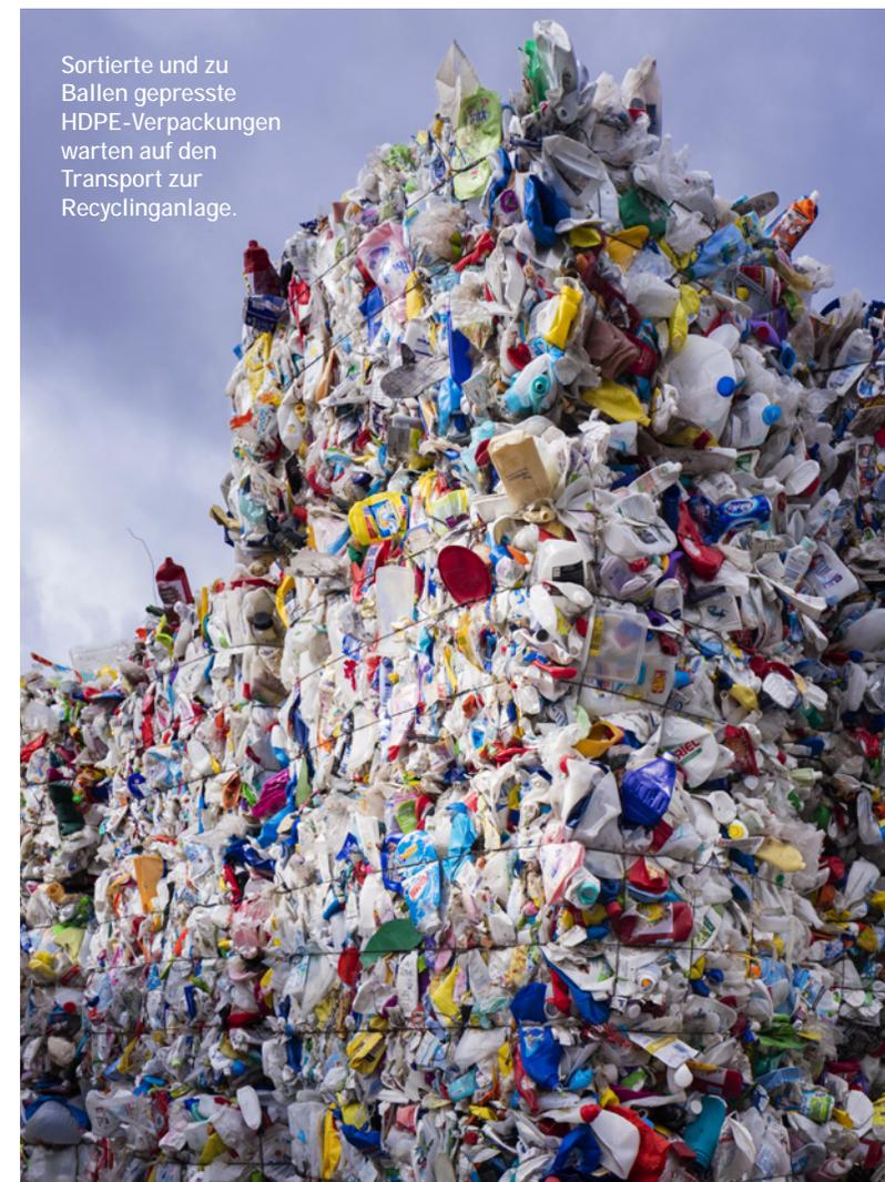
Sortierte und zu Ballen gepresste HDPE-Verpackungen warten auf den Transport zur Recyclinganlage.
