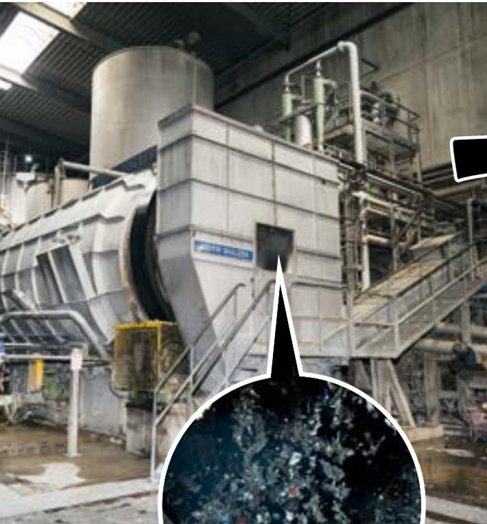
In einer Sortiertrommel wird der braune Faserbrei sorgfältig gereinigt.
